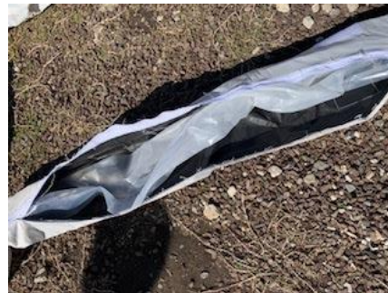
※左写真：破裂したチューブ
